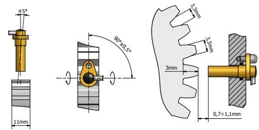
"L'esempio di ruota e gap indicato si riferisce a un profilo fonico di materiale ferroso in uso presso la Elen. L'impiego del sensore su ruota dentata d'ingranaggi con leghe di acciaio e profili diversi richiede certificazione e test da parte della Elen"
