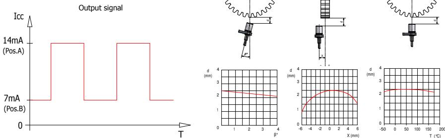
"L'esempio di ruota e gap indicato si riferisce a un profilo fonico di materiale ferroso in uso presso la Elen. L'impiego del sensore su ruota dentata d'ingranaggi con leghe di acciaio e profili diversi richiede certificazione e test da parte della Elen"
