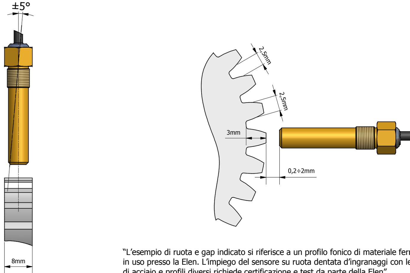
“L'esempio di ruota e gap indicato si riferisce a un profilo fonico di materiale ferroso in uso presso la Elen. L'impiego del sensore su ruota dentata d'ingranaggi con leghe di acciaio e profili diversi richiede certificazione e test da parte della Elen”
