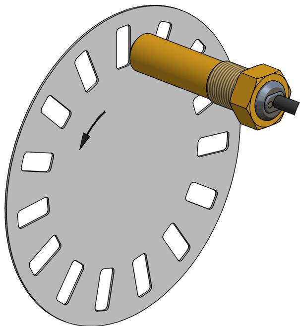
Esempio: Ruota tipo encoder
